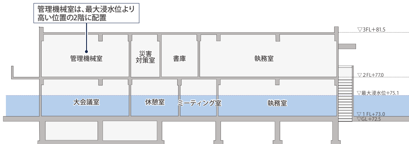
図4 新管理棟の浸水対策イメージ
