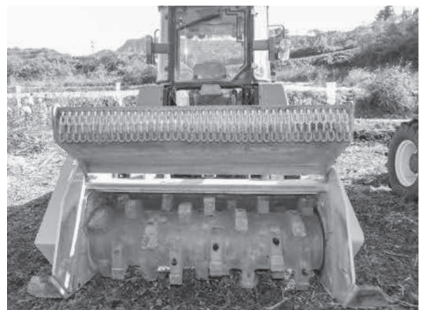
れき 石や礫を粉碎するストーンクラッシャー
